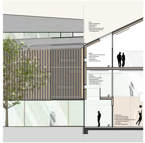
Fassadenschnitt mit Teilansicht
