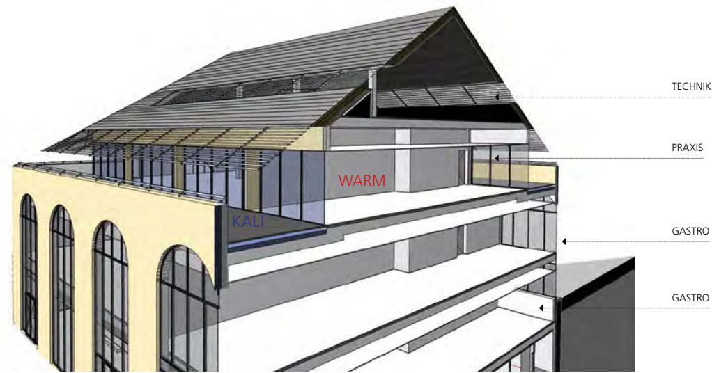
Perspektivischer Querschnitt Bauteil C – Lamellen im Traufbereich mit einer umlaufenden Dachterrasse
